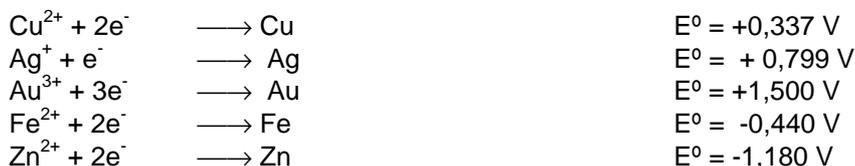
En el ánodo ponemos el metal impuro y en el cátodo una barra de cobre puro, sumergidos ambos en una disolución de iones  $\text{Cu}^{2+}$ .
