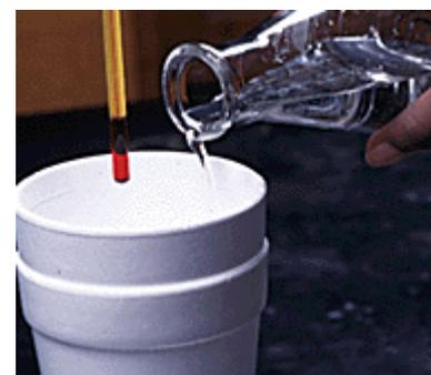
Añadimos un agitador magnético y un volumen conocido del ácido, agitamos y medimos la temperatura (que ha de ser la de la base y la temperatura ambiente) añadimos un volumen estequiométrico de la base, agitamos, y medimos la temperatura final en el punto de equivalencia, conocidos los volúmenes y la densidad, como tenemos la temperatura inicial y final (y el equivalente en agua del calorímetro) el calor desprendido se calcula fácilmente.
