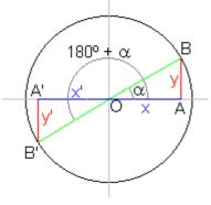
Los triángulos rectángulos AOB y A'OB' son iguales pues tienen los tres ángulos iguales y un lado igual ( el radios , r = 1 , en verde ), luego x = -x' e y = -y'
