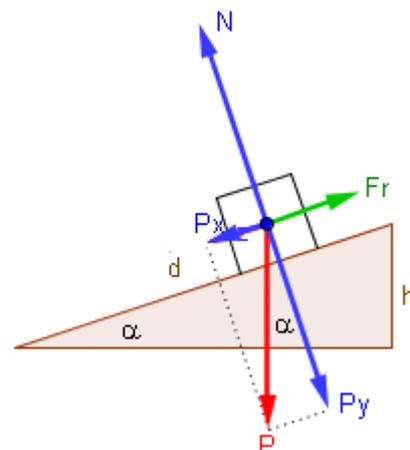
15) Por una pista que tiene una pendiente del 20 % desciende un trineo 100 m. Si su masa es de 80 kg y el coeficiente de rozamiento  $\mu = 0,06$ , calcula:
