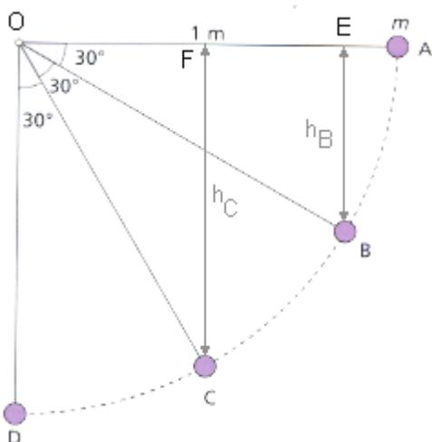
En el triángulo rectángulo OEB,  $\text{sen}30^\circ = \frac{h_B}{L} \Leftrightarrow h_B = L\text{sen}30^\circ$ .
