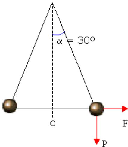
En la figura adjunta se representan las fuerzas que actúan sobre cada esfera del sistema ( además de la tensión que soporta la cuerda ), el peso de cada esfera (  $P$  ) hacia el centro de la Tierra y la fuerza eléctrica repulsiva según la ley de Coulomb.
