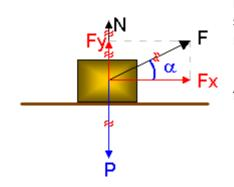
rozamiento dinámico y como la normal es igual al peso ( superficie horizontal) podemos hallar el coeficiente de rozamiento, mediante los pasos :
