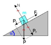
Las únicas fuerzas que actúan son el peso y la fuerza de rozamiento, el peso la descomponemos en sus componentes paralela y perpendicular al plano y es ta última se neutraliza con reacción normal del plano.
