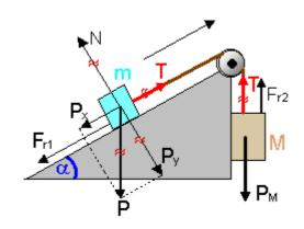
Esta nueva fuerza es  $F_{r2} = \mu \ N_1$ , es decir el producto del coeficiente de rozamiento por la reacción normal del plano sobre el cuerpo de Masa M, como esta reacción es nula ya que no hay fuerza sobre el plano en este sentido y no se puede reaccionar si no existe acción, el sistema de fuerzas queda como en el caso anterior y, por tanto la aceleración con que se mueve el sistema es la misma que en la opción anterior.
