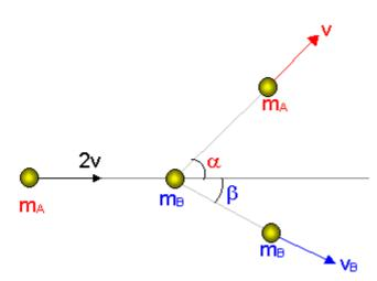
Como no actúan fuerzas exteriores al sistema , se conserva la cantidad de movimiento y si descomponemos el vector cantidad de movimiento según los ejes, colocados en el punto de impacto, también podemos aplicar el teorema de conservación de la cantidad de movimiento según ambos ejes, véase la figura segunda en el que se representan los vectores y sus componentes:
