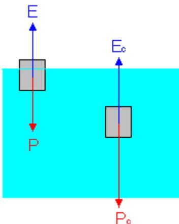
Al flotar es por que están en equilibrio las dos fuerzas que actúan sobre el corcho: el peso del corcho, hacia abajo, y el empuje del agua desalojada por el 70 % de su volumen sumergido, hacia arriba según el principio de Arquímedes, lo que nos sirve para conocer el volumen del corcho :
