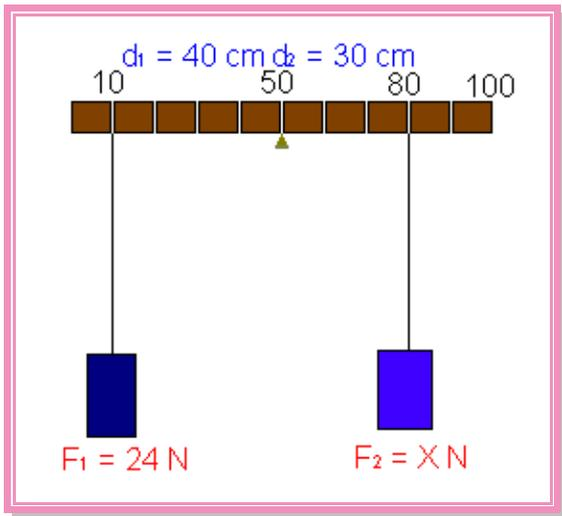
$M_1 - M_2 = 0$  ,  $d_1 \cdot F_1 \cdot \text{sen}90^\circ - d_2 \cdot F_2 \cdot \text{sen}90^\circ = 0$ , ya que los vectores de los momentos son opuestos al ser el sentido de giro de  $d_1$  sobre  $F_1$  hacia abajo y  $d_2$  sobre  $F_2$  hacia arriba del plano que los contiene.
