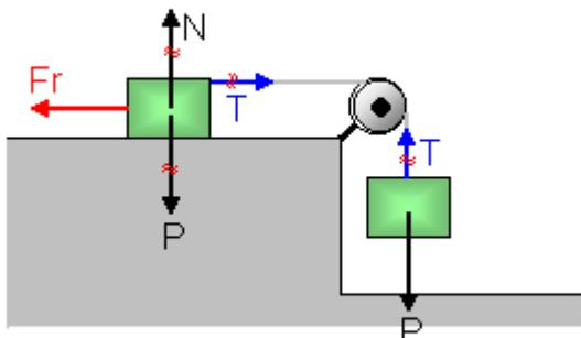
El diagrama de las fuerzas que intervienen, se muestra en la figura adjunta en el que puede apreciarse que después de quitar las fuerzas que se neutralizan la resultante de fuerzas que actúan sobre el sistema son : El peso de la masa que cuelga y la fuerza de rozamiento de la masa que está en el plano sobre este.
