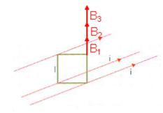
Supuestos los conductores perpendiculares al cuadrado, los vectores campo magnético en el cuarto vértice se dirigen en la dirección del lado hacia arriba, como se muestra en la figura, luego la resultante será la suma de sus módulos
