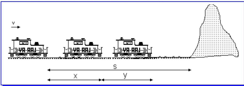
© Espacio que recorre la locomotora mientras recibe el primer eco = velocidad de la locomotora · tiempo que tarda en recibir el eco :
