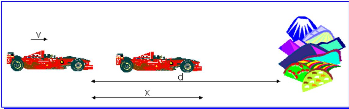
⊗ Espacio que recorre el automóvil hasta que recibe el eco ( en  $t = 2 \text{ s}$ ) =  $x = v \cdot t = 20 \text{ m/s} \cdot 2 \text{ s} = 40 \text{ m.}$
